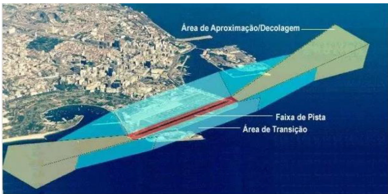
Figura 4 - Superfície de Aproximação, Decolagem e Transição do Aeroporto Santos Dumont, localizado no Rio de Janeiro.
