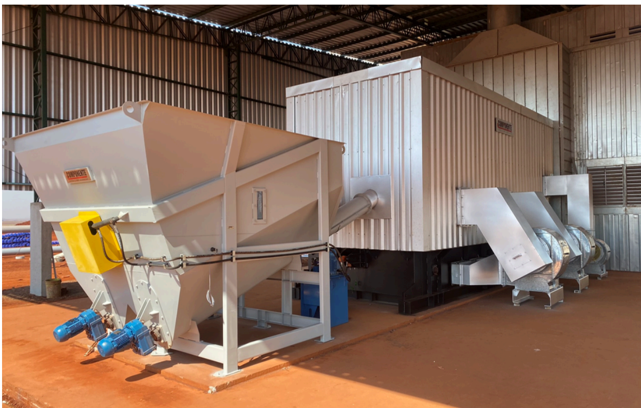
Figura 3 - Conjunto de equipamentos Moega de Roscas + Queimador Stoker.
